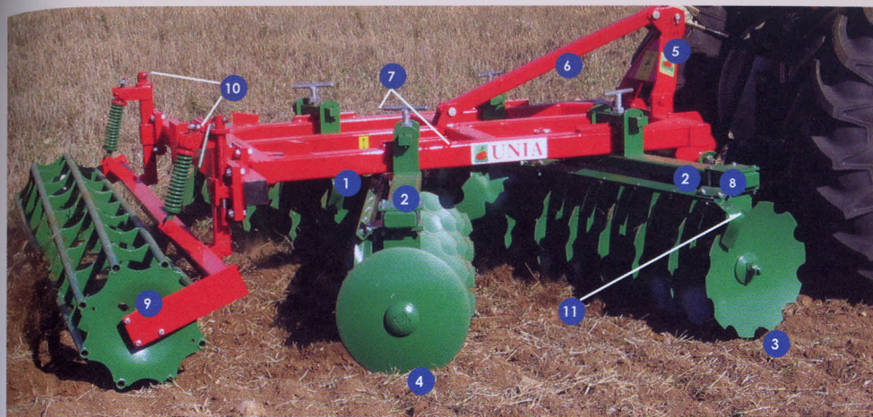
Ryc. III. 18. Brona talerzowa zawieszana czterosekcyjna z wałem strunowym: 1 – rama główna, 2 – rama sekcji, 3 – sekcja przednia, 4 – sekcja tylna, 5 – wspornik zawieszenia, 6 – zastrzał, 7 – śruba regulacyjna z nakładką, 8 – wspornik osi sekcji (mocowany do ramy jarzmami lub śrubami), 9 – wał strunowy, 10 – regulacja śrubowa wału strunowego, 11 – zgarzniacze oczyszczające talerze
