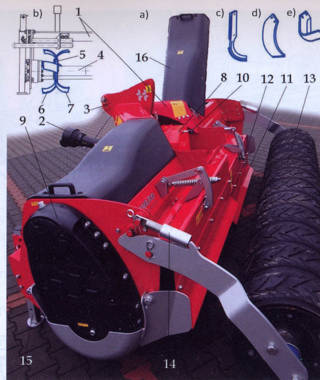
Ryc. III. 23. Glebogryzarka i rodzaje noży: a) widok ogólny, b) sposób zamocowania noży na wirniku, c) nóż łukowy lub nieznacznie odgięty stosowany do mulczowania, d) nóż prosty, e) nóż kątowy; 1 – rama, 2 – WP-T podwieszony na zaczepie prętowym, 3 – stojak zawieszenia, 4 – wał wirnika, 5 – tarcza nożowa, 6 – nóż prawy, 7 – nóż lewy, 8 – przekładnia zębata centralna, 9 – przekładnia boczna, 10 – ciągnio do zmiany przełożenia, 11 – osłona, 12 – śruba regulacyjna osłony, 13 – wał oponowy, 14 – tuleja do regulacji ustawienia wału (głębokości roboczej glebogryzarki), 15 – podpora, 16 – osłona maskująca (prawa) i wału napędowego pośredniego (lewa)
